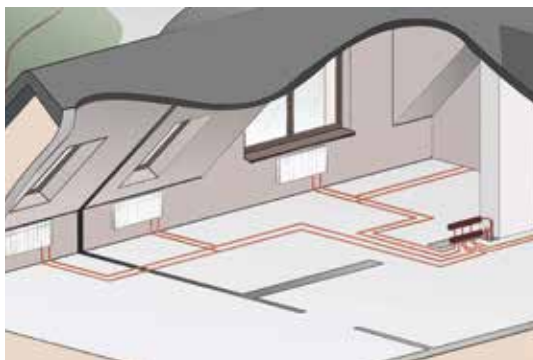
Razdjelnik – T sistem u instalaciji grijanja
