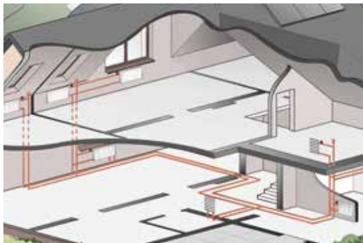
“Vertikalni” sistem u instalaciji grijanja
