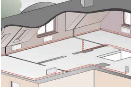
Sistem petlje u dvocijevnoj instalaciji grijanja
